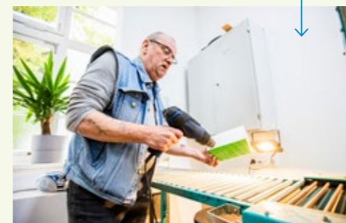
Nach dem Schrumpftunnel werden Dellen und Falten mit dem Fön beseitigt.
