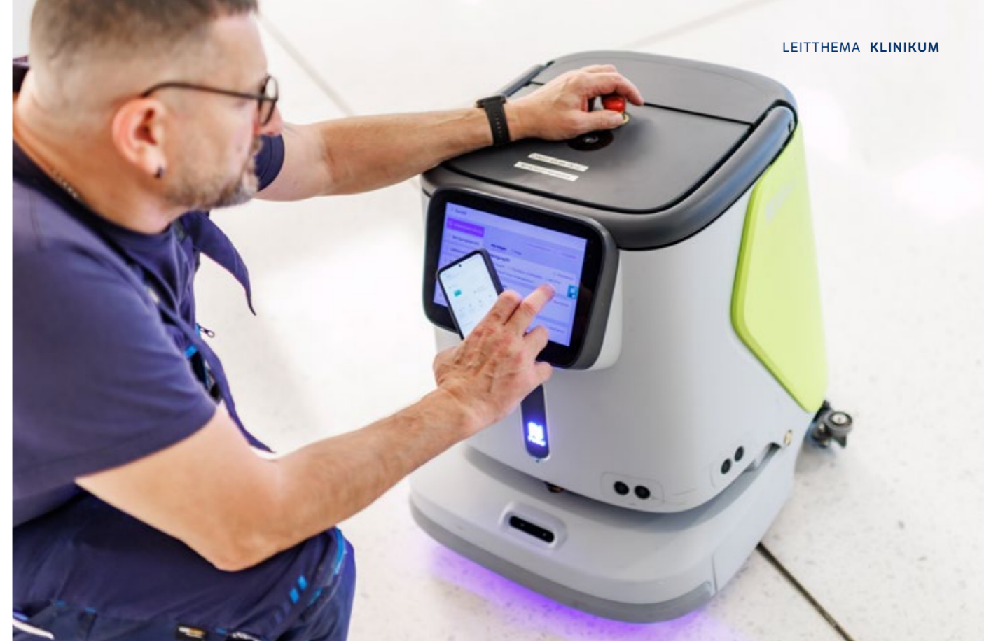
Reinigungsroboter Kalle hat den Gebäudeplan abgespeichert und fährt dreimal täglich das gesamte Erdgeschoss ab.
